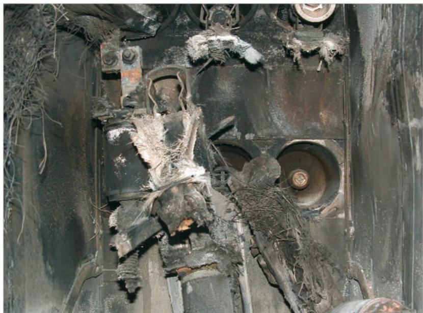
*Bild 1: Anlagenschaden infolge des Versagens einer HH-Sicherung*
