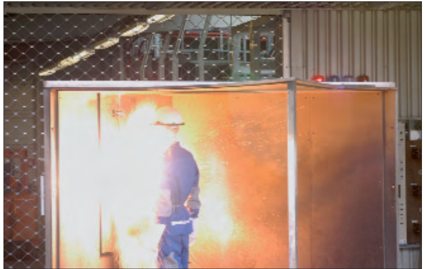
Bild 1: Störlichtbogen können erhebliche Auswirkungen verursachen
