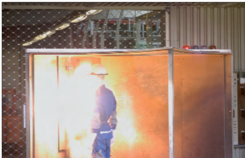
Bild 1: Störlichtbogen können erhebliche Auswirkungen verursachen
